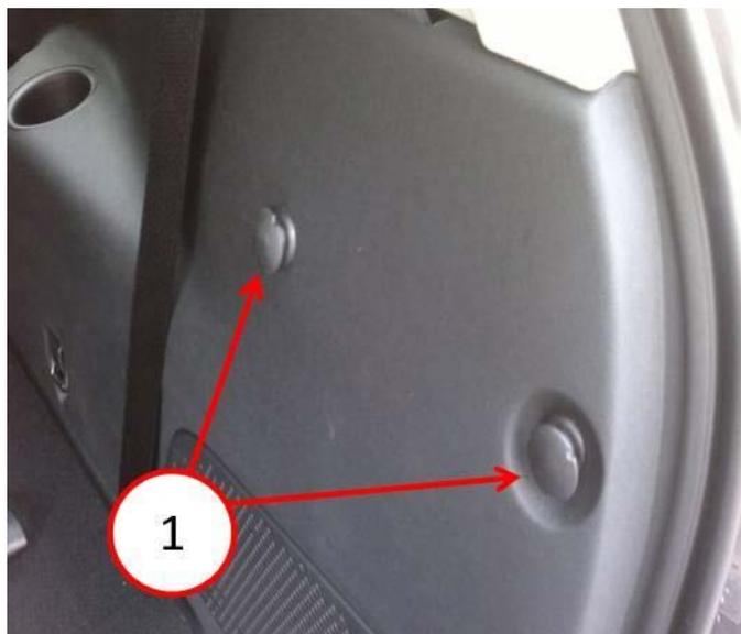
**Fig. 1 Attacchi lato destro vano bagagli**
